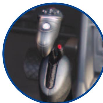
**Einzigartig am Markt ist die werkzeuglose und sekundenschnelle Umsteckfunktion auf das Handbediengerät Multimaz für Gas und Bremse.**
