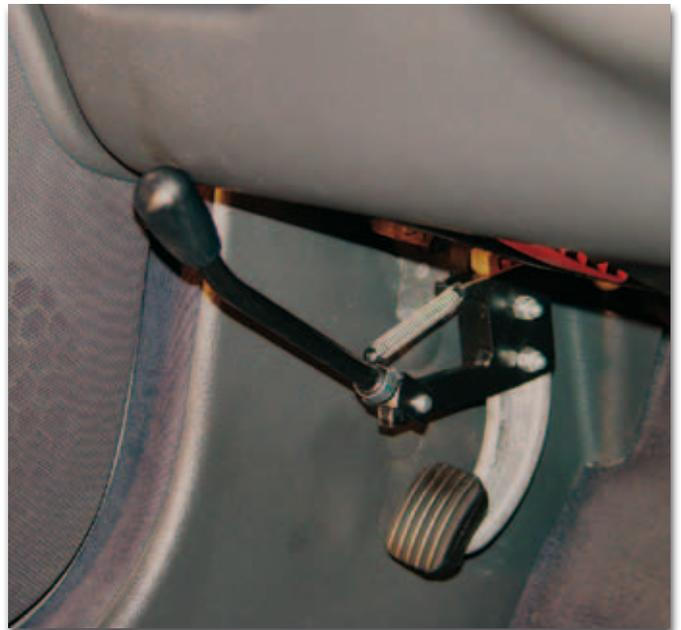
Das vorhandene Fußpedal ist durch einen Bowdenzug mit dem an der Lenksäule befestigten Handhebel verbunden.
