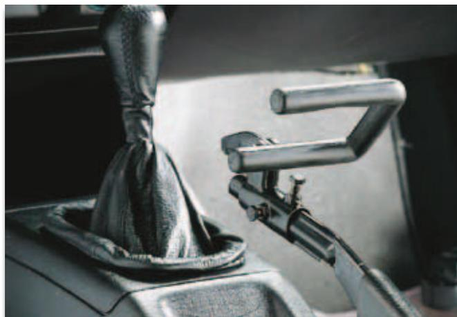
Dieses Gerät ermöglicht die sichere und einfache Bedienung der Handbremse bei eingeschränkter oder verminderter Funktionsfähigkeit der rechten Hand. Auch bei völligem Ausfall der Hand kann das Löse- und Feststellgerät mit dem Unterarm betätigt werden.
