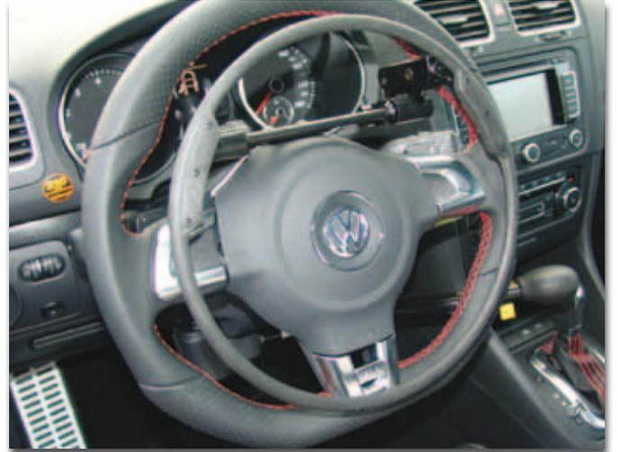
Der Gasring ist für lange Strecken besonders gut geeignet. Das Gasgeben erfolgt ganz einfach durch Drücken des Rings mit minimalem Kraftaufwand. Das Gaspedal wird über die Elektronik des Gasrings gesteuert.
