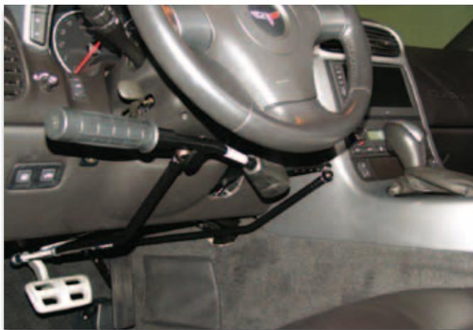
Dieses Gerät wird unterhalb der Lenksäule befestigt. Gas- und Bremspedal sind durch ein Zieh-Drück-Gestänge miteinander verbunden, das mit der linken Hand bedient wird. Bremsen erfolgt durch Druck nach vorn. Zum Gasgeben wird der Handgriff an das Lenkrad herangezogen. Für Fahrer ohne Mobilitätseinschränkung bleiben die Originalpedale komplett erhalten.
