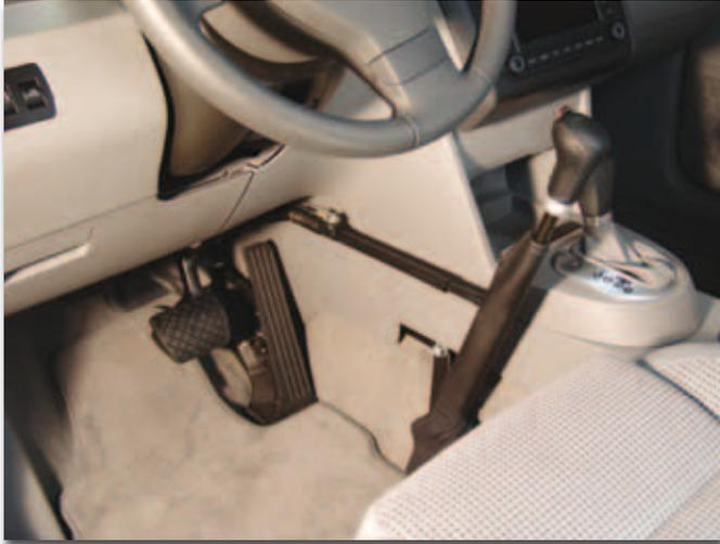
Nach wie vor im Petri + Lehr Sortiment ist das Handbediensystem Multima1. Auch bei diesem Gerät wird durch Ziehen des Bedienhebels beschleunigt, und durch Drücken nach vorne gebremst das Fahrzeug ab.
