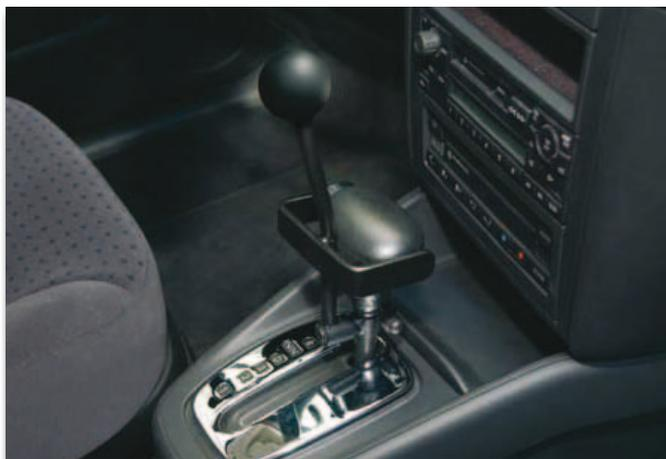
Die Schalthebelverlängerung wird bei Kraftfahrzeugen mit Schalthebelarretierung am Schaft angeklemt. Durch seitliches Drücken wird die Arretierung gelöst. Anschließend können die einzelnen Gangstufen eingelegt werden. Bei Kraftfahrzeugen ohne Schalthebelarretierung wird die Originalkugel abgeschraubt und die Schalthebelverlängerung aufgesteckt.
