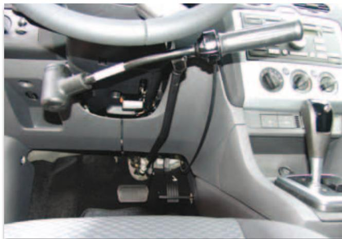
Die Bedienung der Bremse erfolgt bei diesem Gerät durch Drücken des Bremshebels. Das Gasgeben erfolgt durch eine Drehung am Handgriff wie bei einem Motorrad. Das Gerät ist wahlweise mit und ohne Feststellung der Fußbremse lieferbar. Mit einer zusätzlichen Taste kann die Fußbremse arretiert werden.
